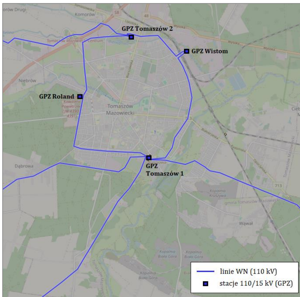
Rysunek 7. Infrastruktura elektroenergetyczna wysokiego napięcia (110 kV) na terenie Miasta Tomaszowa Mazowieckiego
