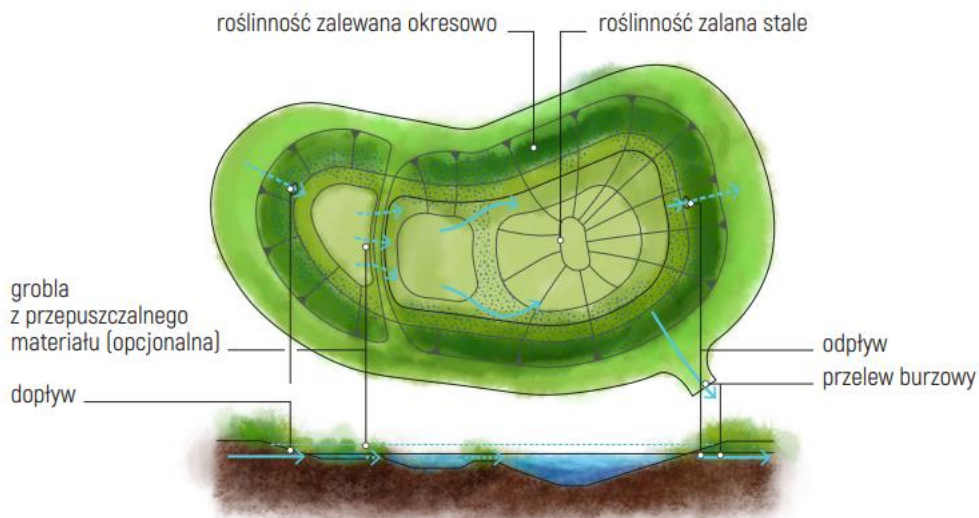
Rysunek 17. Schemat typowego stawu retencyjnego, widok z góry i przekrój.
