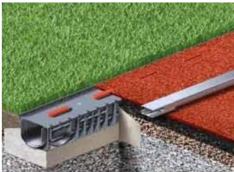
Rys. 1 Przekrój odwodnienia szczelinowego pod nawierzchnią bieżni
