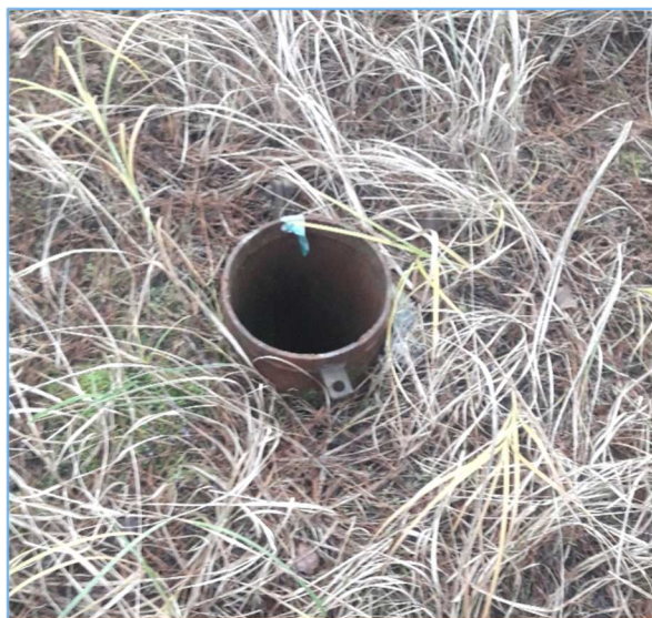
Fot. nr 16 Zlokalizowany piezometr nr 5
